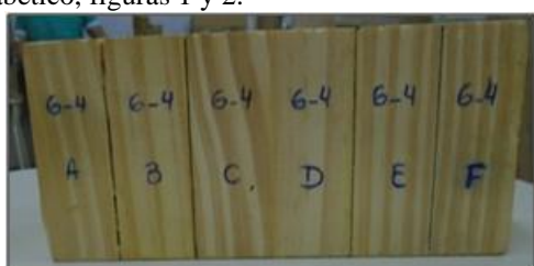
Figura 1: Vista lateral de la probeta para ensayo de cizallamiento.
