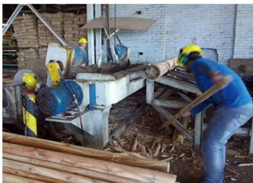
Imagen 1: Operario retirando manualmente meollos atascados uno a uno, así como los residuos del torno. Image 1: Operator manually removing cores one by one and veneer waste
