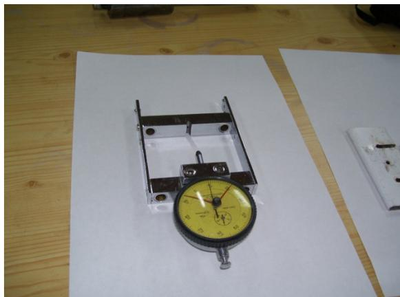
Figura 2 – Extensómetro terminado
